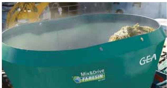
Продуманная конструкция: верхняя кромка с обратным наклоном в смесителях *Mix&Drive* серии *M* обеспечивает постоянный сброс поднявшегося корма обратно в контейнер.
