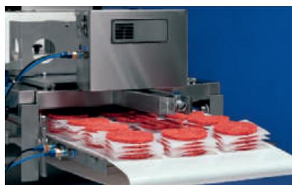
Укладчик бумаги GEA осуществляет автоматическое переключивание бумагой продуктов в различных сочетаниях
