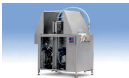
Запираемые, легко снимаемые боковые панели дают доступ к инжектирующей головке и другим компонентам
