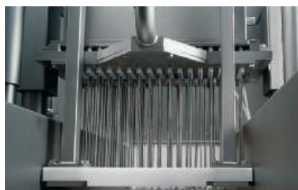
Инжектирующая головка оснащена датчиком высоты продукта для минимизации расхода рассола
