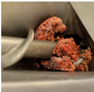
Медленно вращающийся загрузочный шнек режет, а не разламывает замороженные блоки
