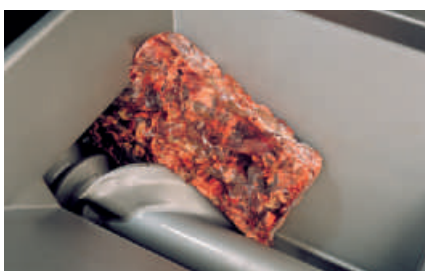
Медленно вращающийся подающий шнек разрезает, а не разбивает блоки с замороженным мясом
