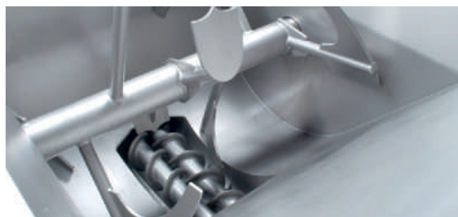
Широкая подача и медленно вращающаяся мешалка в бункере
