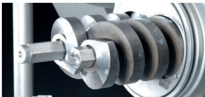
Сцепленные шнеки, которые работают как поршневой насос
